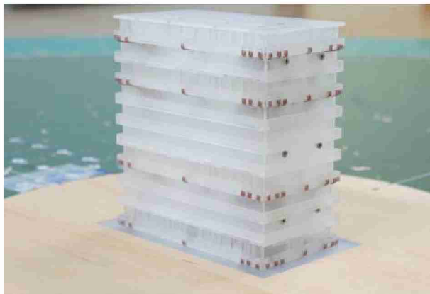
(b) 手すり測定用風圧模型
